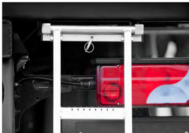
17 Лестница для доступа в фургон под правой дверь оцинкованная выдвижная с 2 ступенями.
