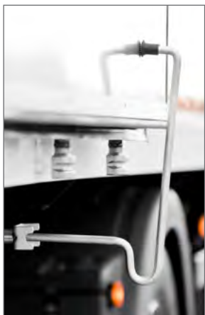
16 Фиксатор двери в открытом положении оцинкованный Т-образный (РФ), 2 шт. (при ширине фургона до 2400 мм вкл.) либо оцинкованный пружинный Г-образный (РФ), расположенный под фургоном.
